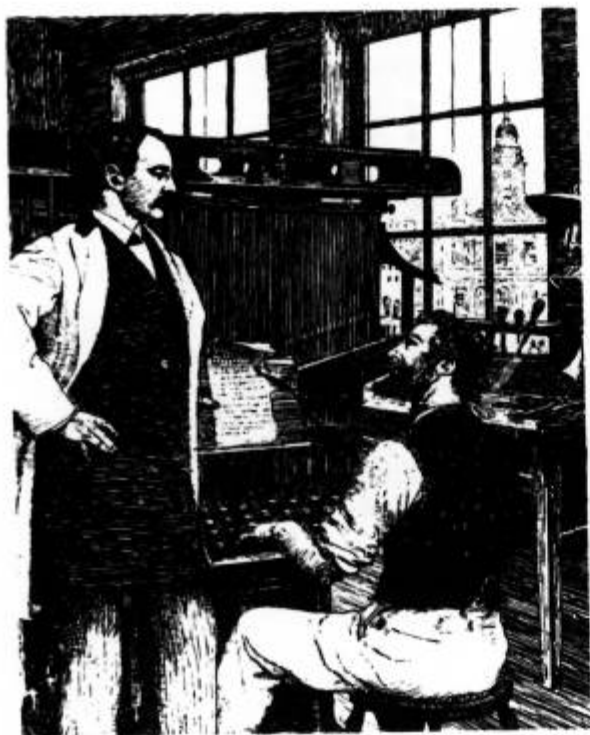
1—15. 1886年7月发明的第一台键盘式排版机的成功改变了原来的手工排字的低效率情况，大大促进了印刷事业。
