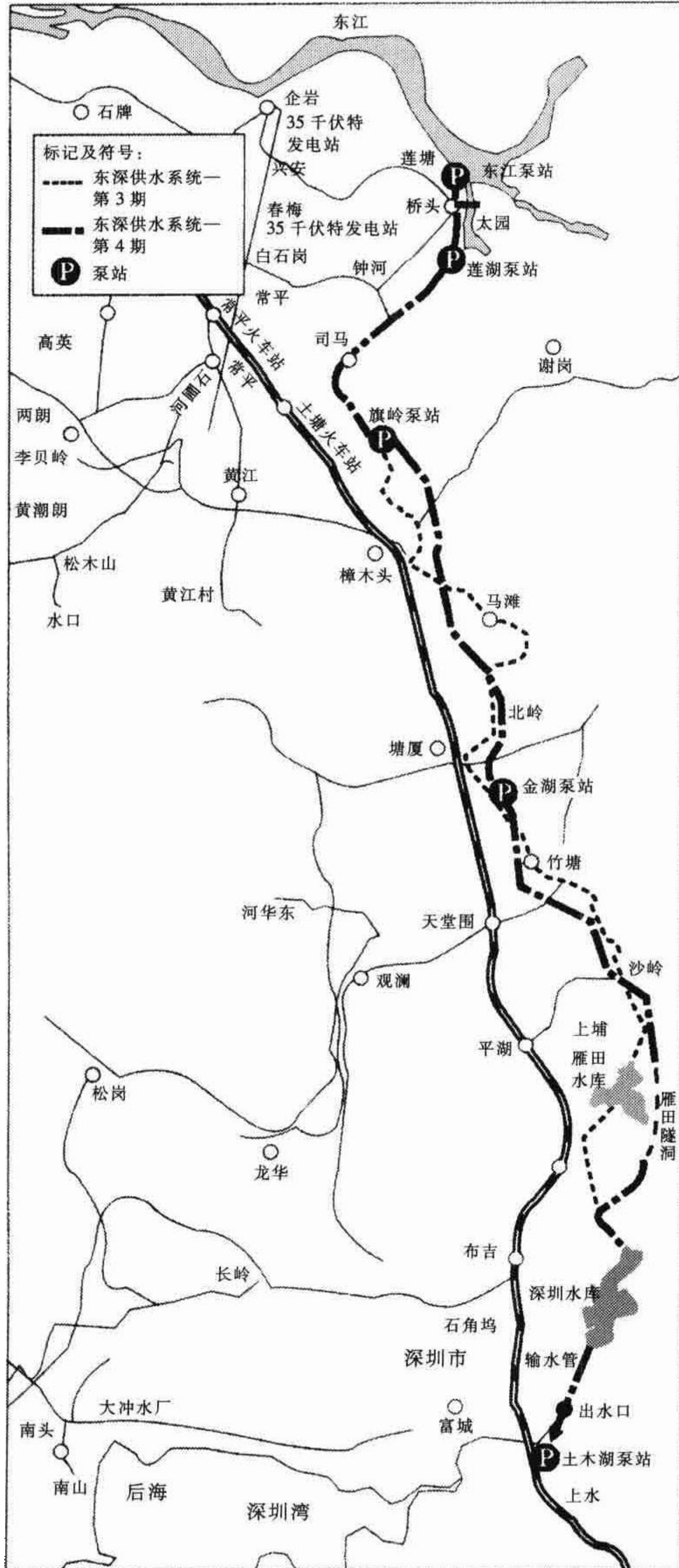
图 3.1 东深供水项目从取水口至深圳水库规划图
