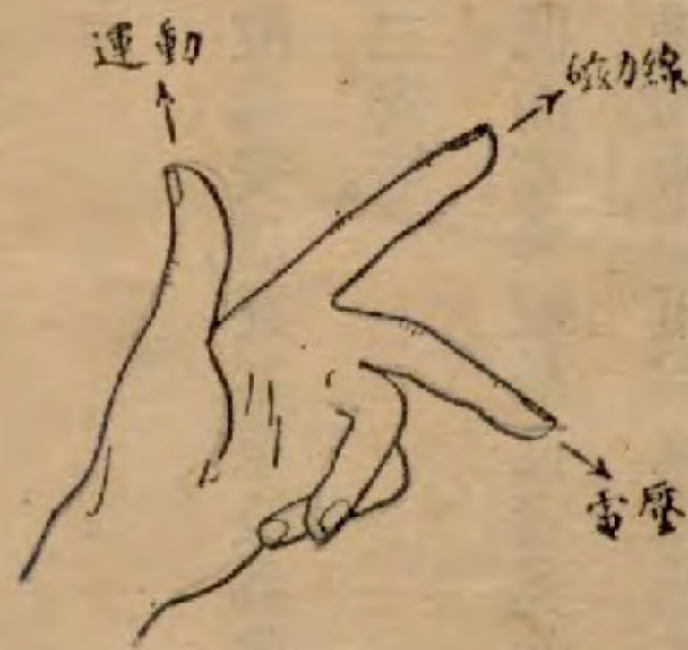
第五圖 佛來銘左手定則 ——電動機作用
