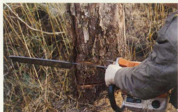
伐木作業示範，先鋸三角切口，即倒木方向，再由另一面鋸倒（1987.12.16）。
