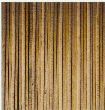
以生長錐鑽取生長輪，定位於木條，砂紙磨平後，始可進行較準確的計算與度量。
