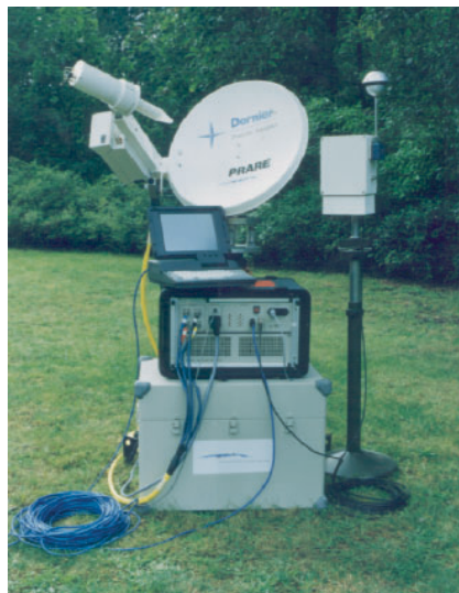
Abb. 12: Eine Bodenstation des mit Radiowellen – wetterunabhängig – arbeitenden Satellitenbahnverfolgungssystems PRARE.
