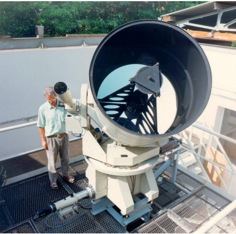
Abb. 11: Laserteleskop des GFZ Potsdam zur Bahnverfolgung von Satelliten.
