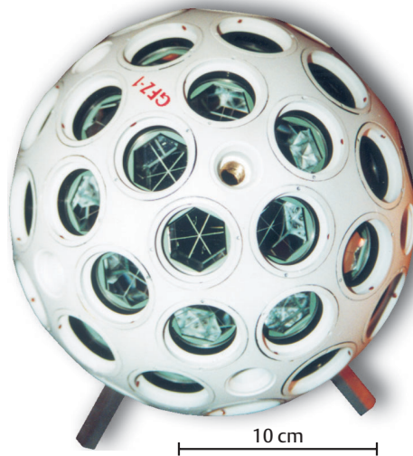
Abb. 6: Der passive Kleinsatellit GFZ-1 umrundete die Erde von 1995 bis 1999 in einer Höhe von anfänglich 390 km.
