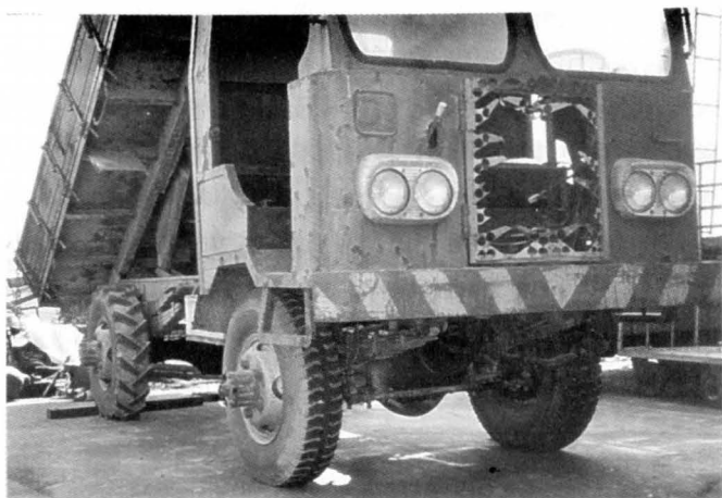
圖十七、前輪為一般輪胎，著重速度。後輪為人字齒，著重抓力。筆者攝於西螺鎮。
