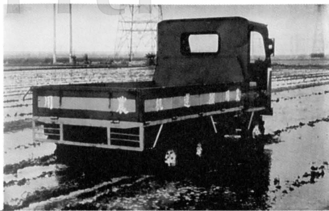
圖十六、能夠在泥濘田地中工作的十輪傳動拼裝車。資料出處：育成農機工廠
