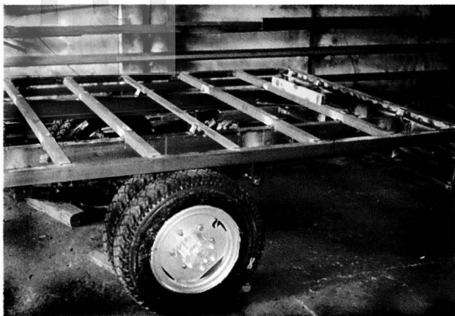
圖十八、槽仔鐵(門型鋼)為骨架之拼裝車車身,載重由其槽仔鐵決定。六槽長高厚及轉角厚度各為150mm、75mm、7.5mm、13mm;四槽為100mm、50mm、5.5mm、10mm;三槽為75mm、40mm、5mm、10mm。重點在於高度。攝於西螺鎮。
