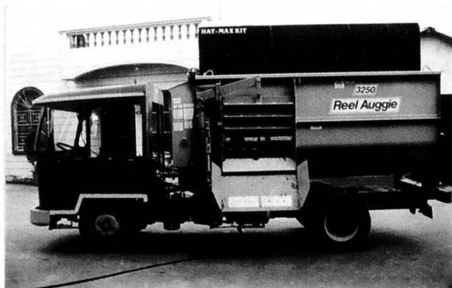
圖廿四、政府專案補助之酪農飼料攪拌車。M2受訪者提供。
