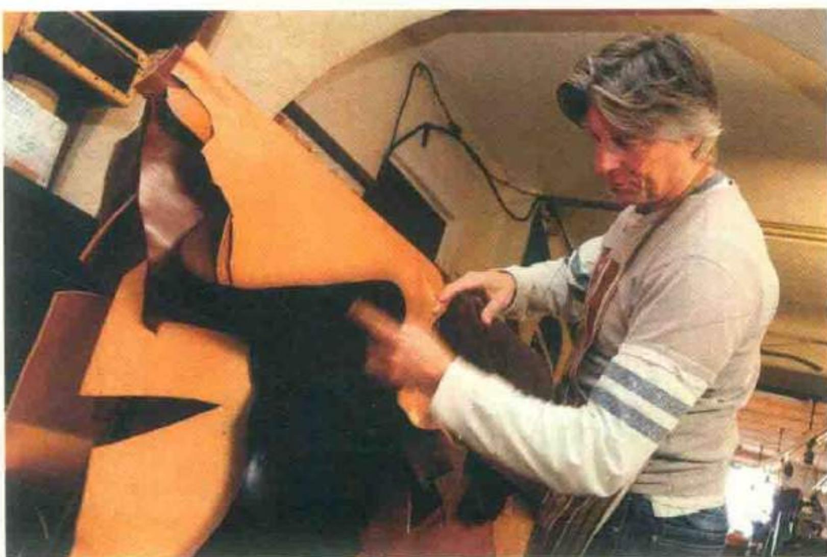
鞋面多采用牛皮、鳄鱼皮、鸵鸟皮、蛇皮、大象皮等皮革来制作。这些皮革多产自瑞士、波兰、印度等国家。用来制鞋的皮革，既需不易变形，又要有一定的柔韧性。
