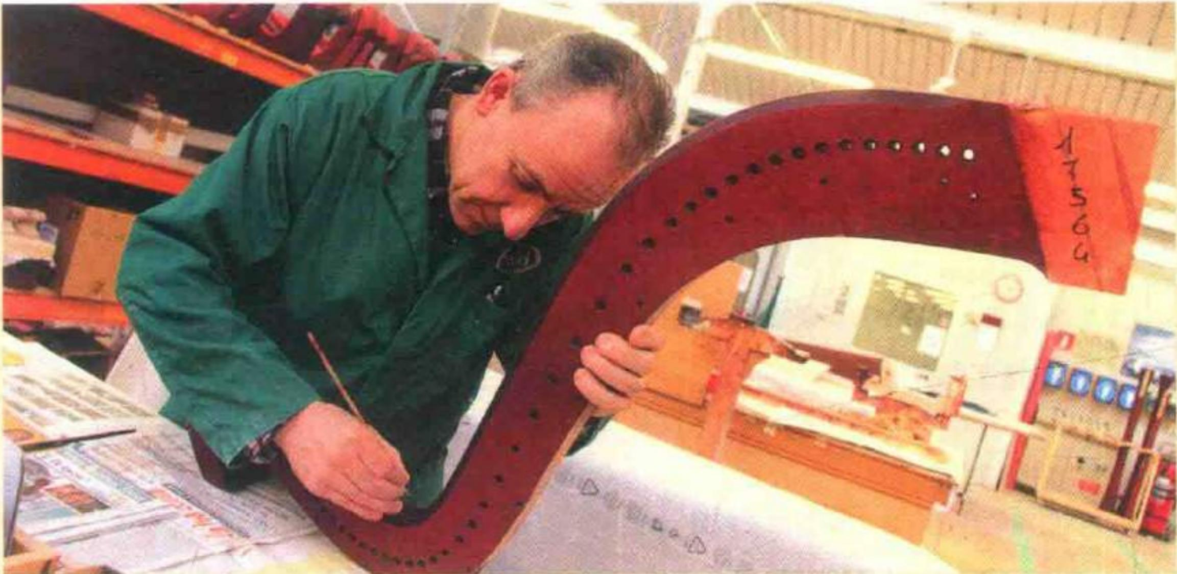
位于皮亚斯科的竖琴工坊。图中的工匠正在制作板梁部分。
