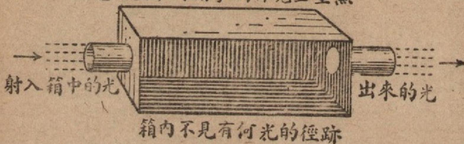
(圖九) 在無塵空氣中通過，絕無可見的散射現象。
