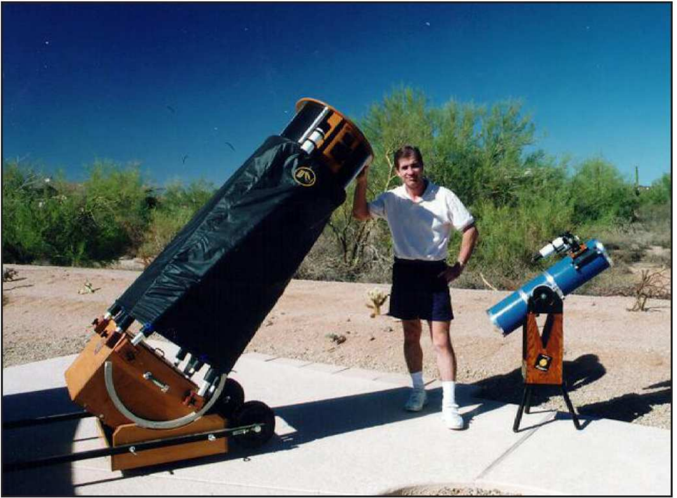
盖因·汉森和他的 18 英寸 ( 46cm ) f/4.5 反射镜和 6 英寸 ( 15cm ) f/5 反射镜。
