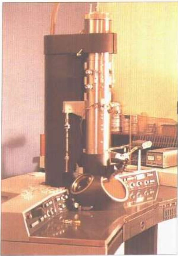
图9 电子显微镜 可见在电子显微镜镜体顶部的电子枪(e)、及样品室(s)和荧光屏(f)。
