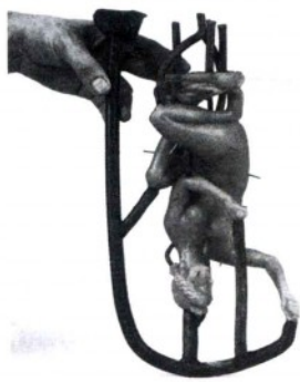
图8 带有通道的模型，用于浇注铜以及排气
