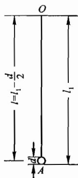
图 1-2 测量摆长的示意图
