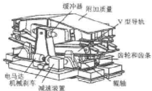
图 11.11.3 V 型混合调谐质量装置
