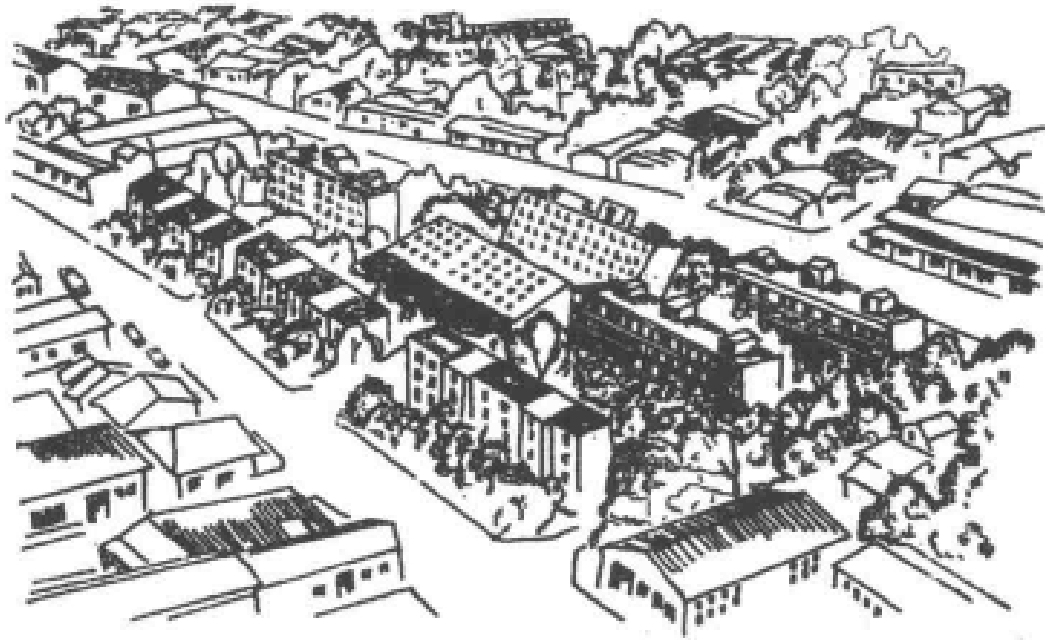
图 8.1.4 新潟地震时的房屋倾倒现象
