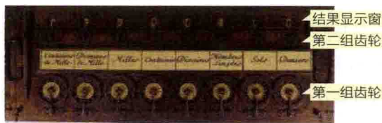
图 19.5 帕斯卡计算器（由上下两组齿轮构成，每一个齿轮代表十进制数字中的一位，收藏于美国硅谷的计算机博物馆）
