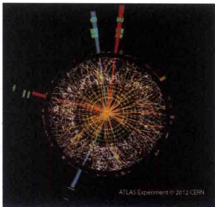
图 23.12 ATLAS 实验接收装置，两束高能粒子对撞后，产生新的粒子，四周环形的探测器收集所需要的数据
