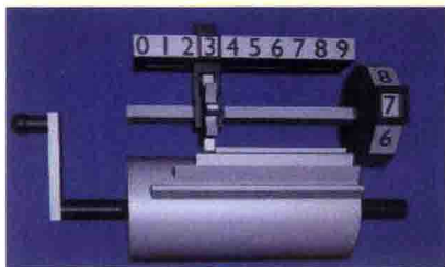
图 19.6 莱布尼兹轮是机械计算器中重要的部件，通过转动数码盘来完成加减计算
