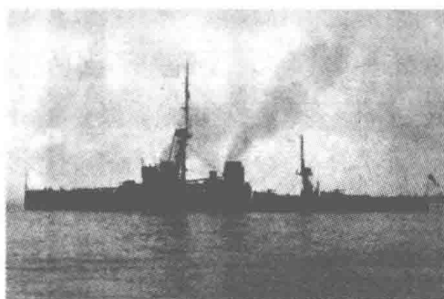
图 3-2 无畏战舰（装备 10 门 12 英寸主炮，航速为 21 节，拥有当时无与伦比的攻击力和航速。WPS 提供）
