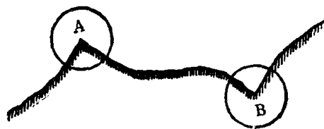
图 7.1 粗糙表面的剖面图
