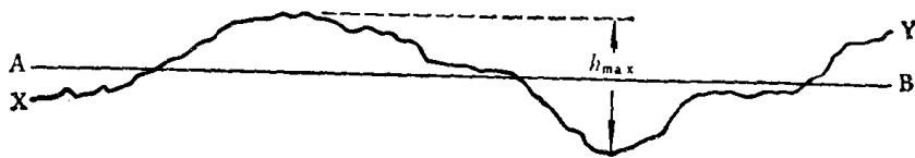
图 7.25 固体表面(剖面)的轮廓线(示意图)
