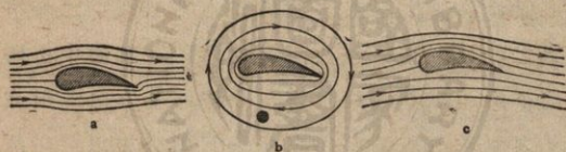
第 114 圖 飛機翼之理(Prandtl 氏原作) a. 位流 b. 環流 c. 合流
