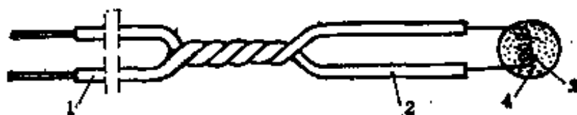
(b) 电力点火装置
