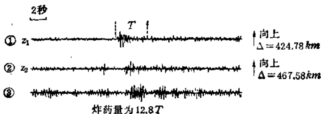
图 7-5 在不同距离上测到的爆炸地震波波形
