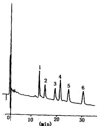
图 11.16 血清中马烯雌酮和马萘雌酮及其代谢产物经免疫萃取预处理后的色谱分离分析 色谱柱: 150 \times 4.6 mm i. d. 填充 Cosmosil-AR; 流动相: 60mmol/L 乙酸缓冲液 (pH 5)/ 甲醇/乙腈 (60/9/30, V/V/V); 双电极电化学检测: 第一电极加电压 +0.1V; 第二电极加电压 +0.8V; 流量: 1ml/min。 色谱峰: 1. 二羟基马烯雌酮; 2. 2-甲氧基二羟基马烯雌酮; 3. 马萘雌酮; 4. 马烯雌酮; 5. 2-甲氧基马烯雌酮; 6. 1-甲萘雌酮。
