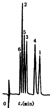
图7.28 抗抑郁药物在ORM预测的优化条件下的色谱分离图(除预测的流动相为 66.7\% , 4.1\% \text{C} 和 29.2\% \text{D} 以外, 其它条件与图7.27 相同)
