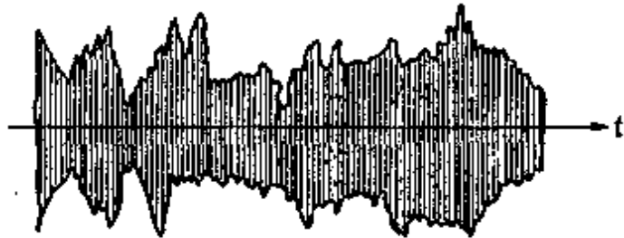
图 4—42 噪声电压的波形
