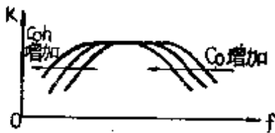
图 4—27 C_{0k} 及 C_{0c} 对幅频特性的影响
