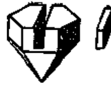
图 7-22 石英晶体的切割
