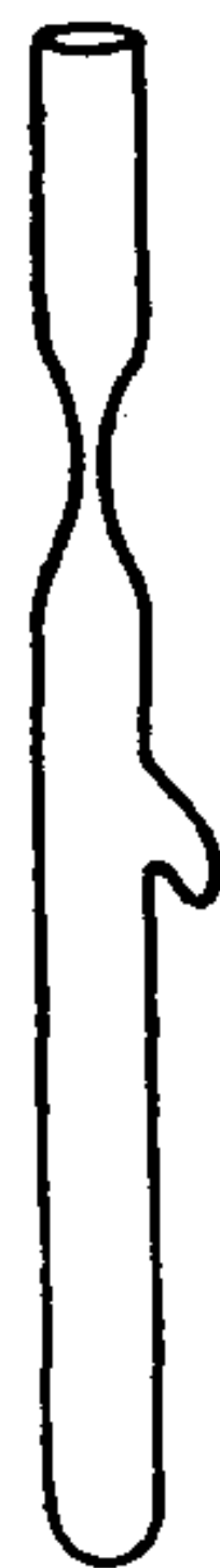
图1 装有侧支管的试瓶
